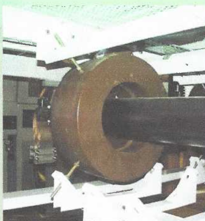
ABG-24 Transformador de corrente para geração desenhado para suportar altas correntes primárias.
