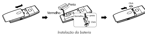
Instalação da bateria
