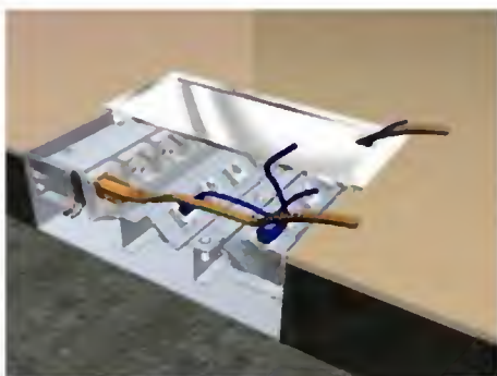
Detalhe de utilização da caixa de tomada tripla embutida - tampa lisa com requadro
