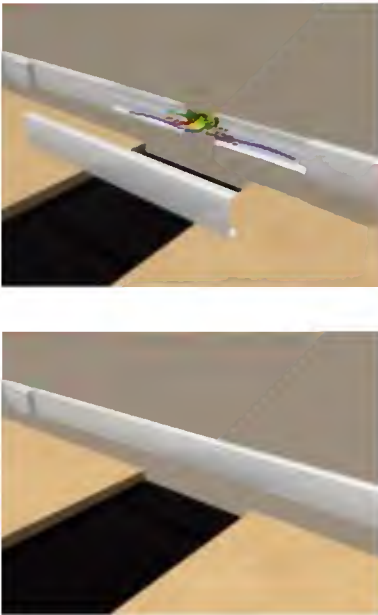
Alimentação do sistema através de caixa 4x2 embutida
