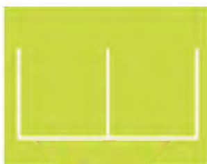
38x76x1100mm Com septo divisor na parte central e furos oblongos nas extremidades
