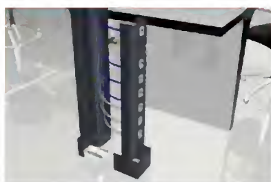
Vista isométrica do suporte para RJ e anel de arremate
