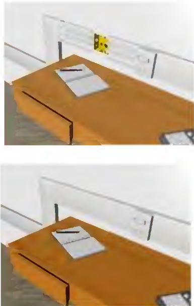
Alimentação do sistema através de caixa 4x4 embutida
