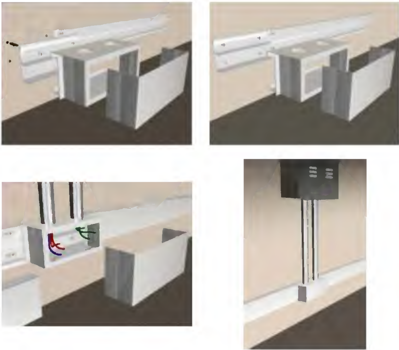
Alimentação do sistema através de caixa de derivação para eletroduto
