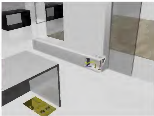
Exemplo de aplicação da caixa na função "embutida" para pontos distantes da parede
