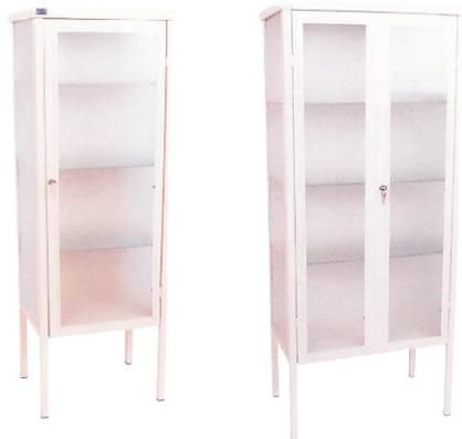
Armário vitrine com 1 porta - tampo, costas e fundo construído em chapa de aço, pés em tubos quadrados com ponteiras, porta com presilhas para fixação dos vidros e fechadura tipo yale. Laterais e porta de vidro incolor de 3mm e três prateleiras também em vidro incolor de 4mm. Pintura eletrostática à pó. Dimensões: 400 x 500 x 1500 mm de altura. RT 20.001.
