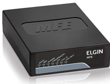
Com processador de última geração e fonte de alimentação externa, oferece ainda mais agilidade e confiabilidade. Possui duas portas de rede ethernet, dispensando a necessidade de instalação de um ponto adicional. Não é necessário re-homologar nos softwares de Automação Comercial. Perfeito para trabalhar em conjunto com as impressoras Elgin, modelos i7 ou i9. Tecnologia GPRS. Receptor GPS. Conexão 3G. 1 porta USB.
