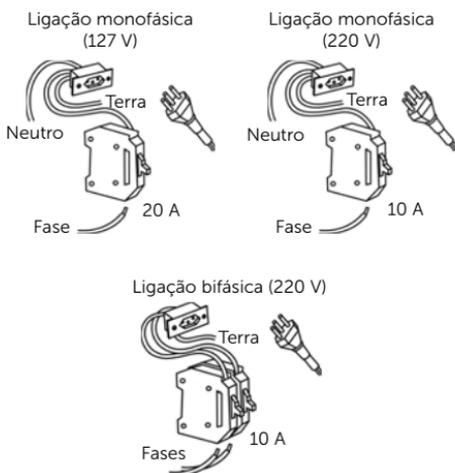
Para modelos 127 V, utilizar uma tomada de 20 A. Para modelos 220 V, utilizar uma tomada de 10 A. As tomadas devem estar de acordo com a norma ABNT (Associação Brasileira de Normas Técnicas) NBR 14136.
