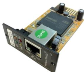
A placa SNMP, permite conexão remota com o nobreak, sem a necessidade de instalação de software. O acesso é simples e feito por qualquer browser bastando digitar o endereço IP correspondente.
