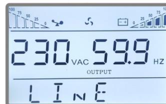
Display contém informações de rede, bateria, carga ligada ao nobreak e informações de falha. Facilmente se consegue navegar pelas telas e visualizar as informações.
