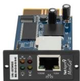
A placa SNMP, permite conexão remota com o nobreak, sem a necessidade de instalação de software. O acesso é simples e feito por qualquer browser bastando digitar o endereço IP correspondente.
