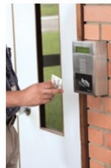
O poder da tecnologia MCA num terminal compacto que pode ser usado tanto para ponto quanto para acesso. O terminal pode acionar até três dispositivos separados como, por exemplo, uma fechadura eletromagnética, cancelas, portões motorizados, câmeras e muitos outros. A rede TCP/IP consulta bancos de dados de maneira rápida e confiável.
