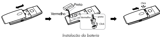
Instalação da bateria
