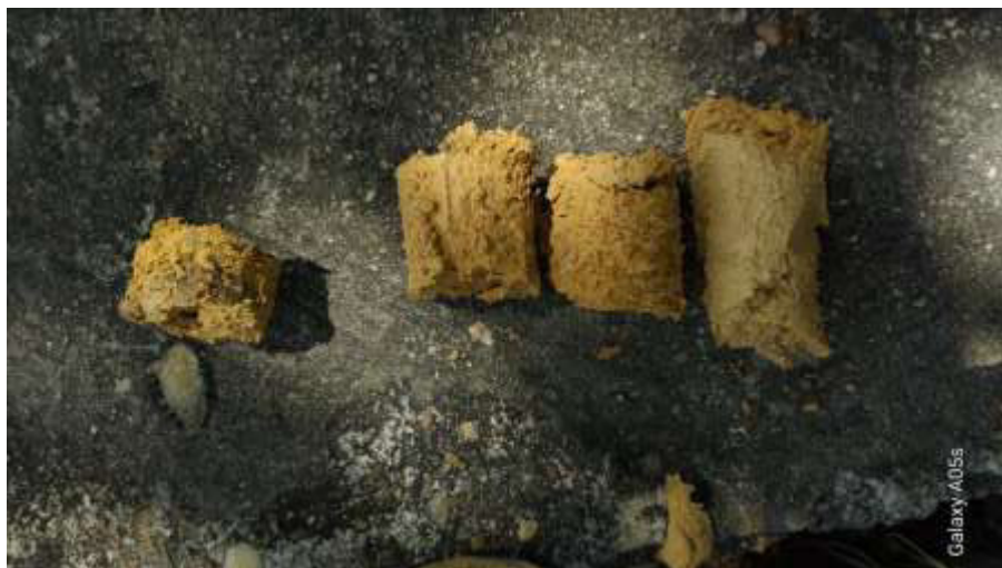
Figura 4: Amostra da camada S1 – Argila siltosa de cor amarelada.
