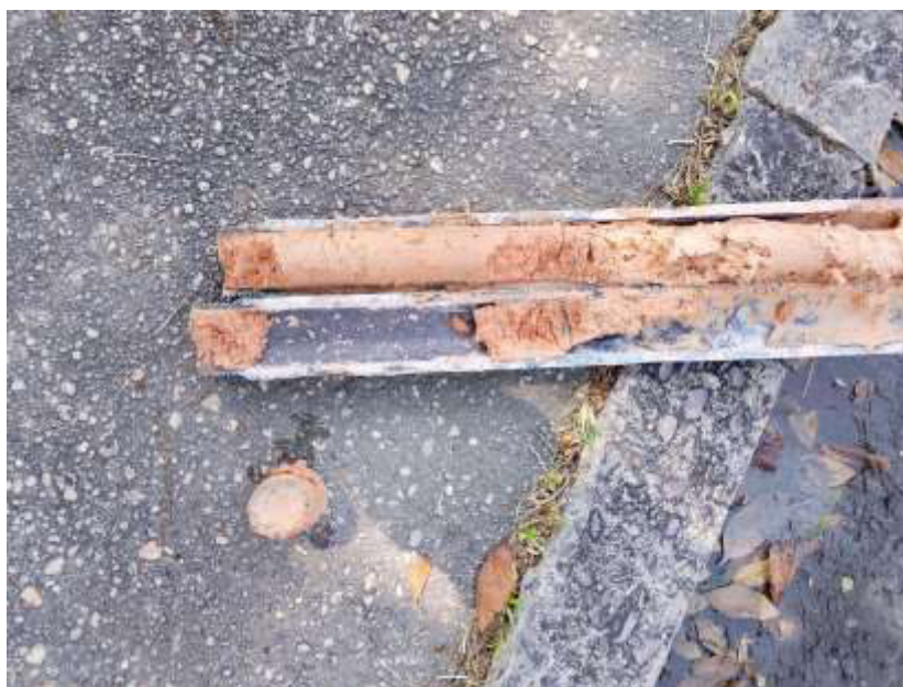
Figura 5: Amostra da camada S2 – Argila arenosa de cor avermelhada.
