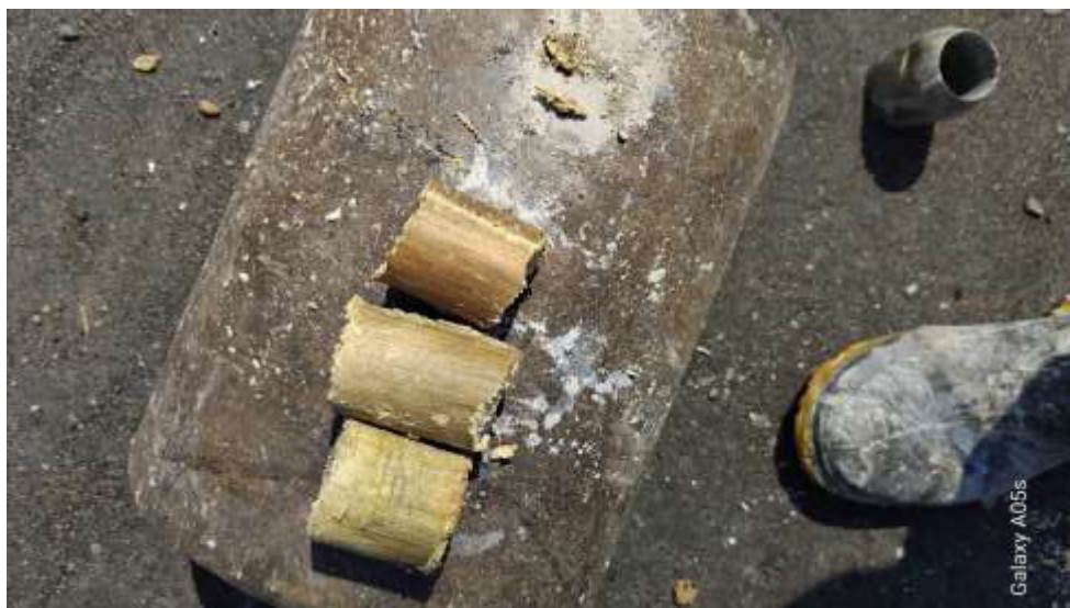
Figura 6: Amostra da camada S4 – Silte cinza claro.
