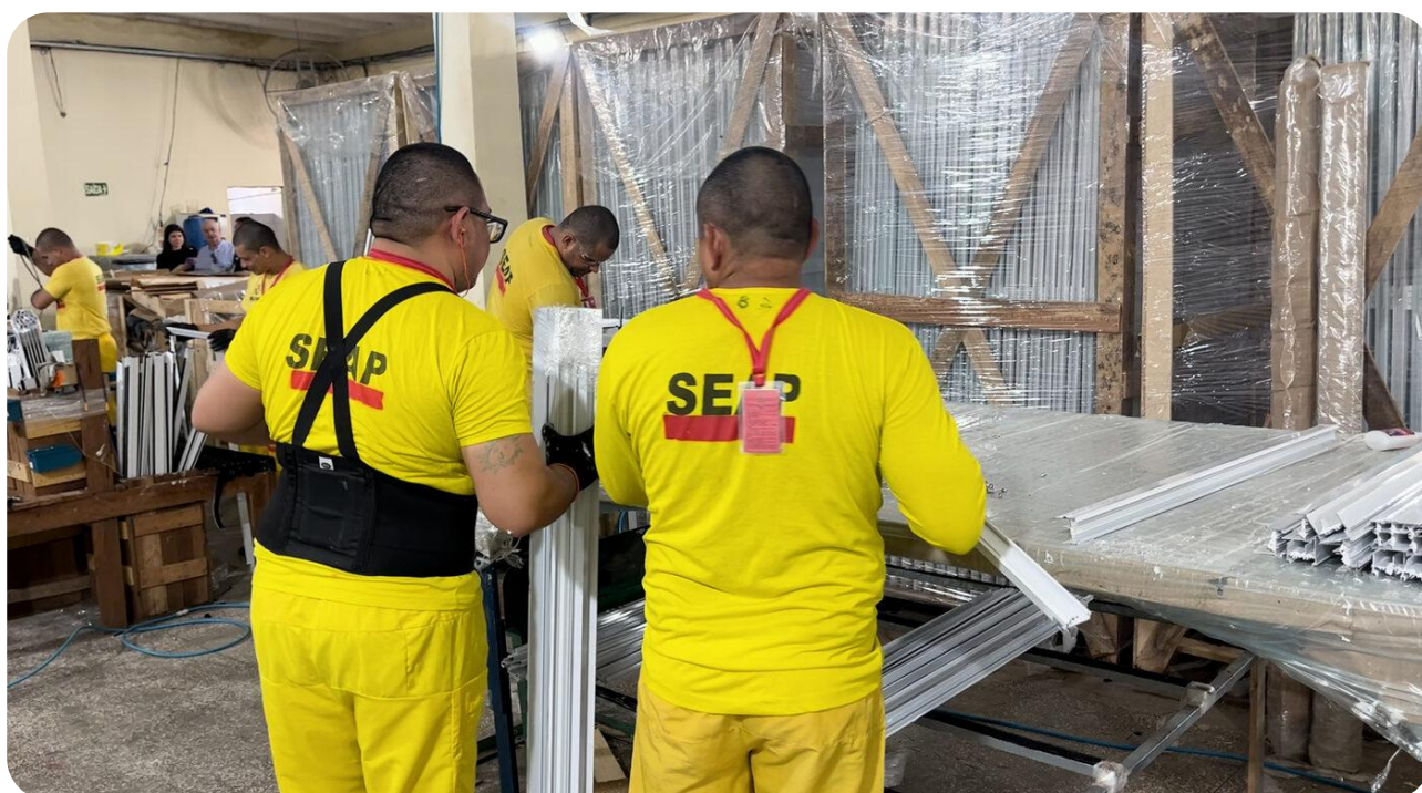
Linha de montagem de esquadrias de alumínio — IBRAP.
