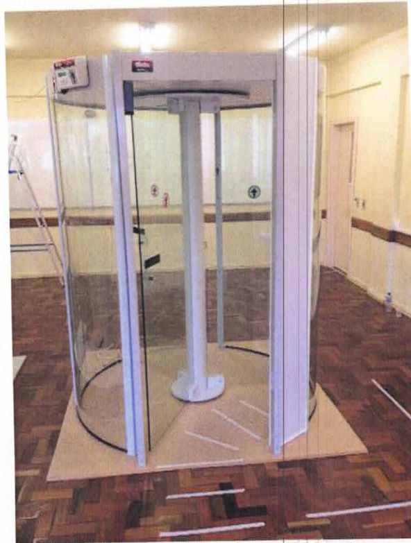
Figura 14 – Fotografia da Porta Giratória Ensaçada.
