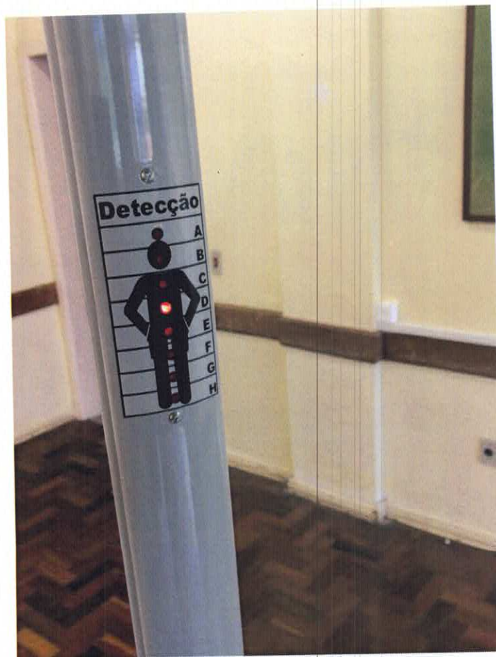
Figura 19 – Detalhe do Painel Com Indicador Luminoso Interno.
