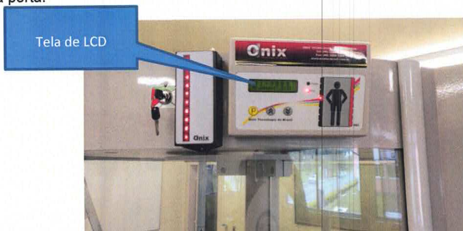
Figura 20 – Detalhe Painel – Indicador Luminoso.
