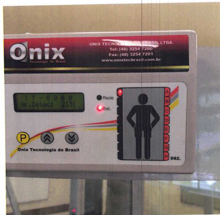
Figura 17 – Painel Com Indicador Luminoso Externo.
