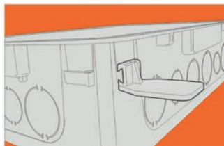
Posição B: duas placas de gesso acartonado
