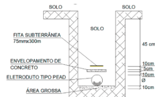
Figura 3 - Instalação de eletrodutos subterrâneos
