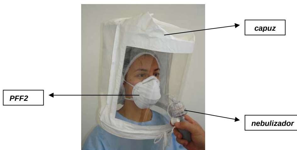
Figura 20: Capuz e nebulizador utilizados nos ensaios de vedação qualitativo com névoa de sacarina ou bitrex
