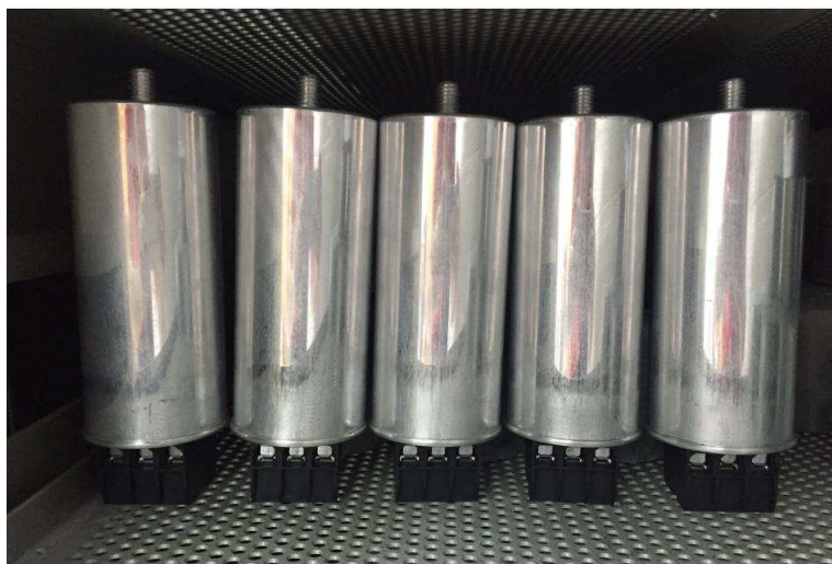
Figura 3: Teste de estanqueidade
