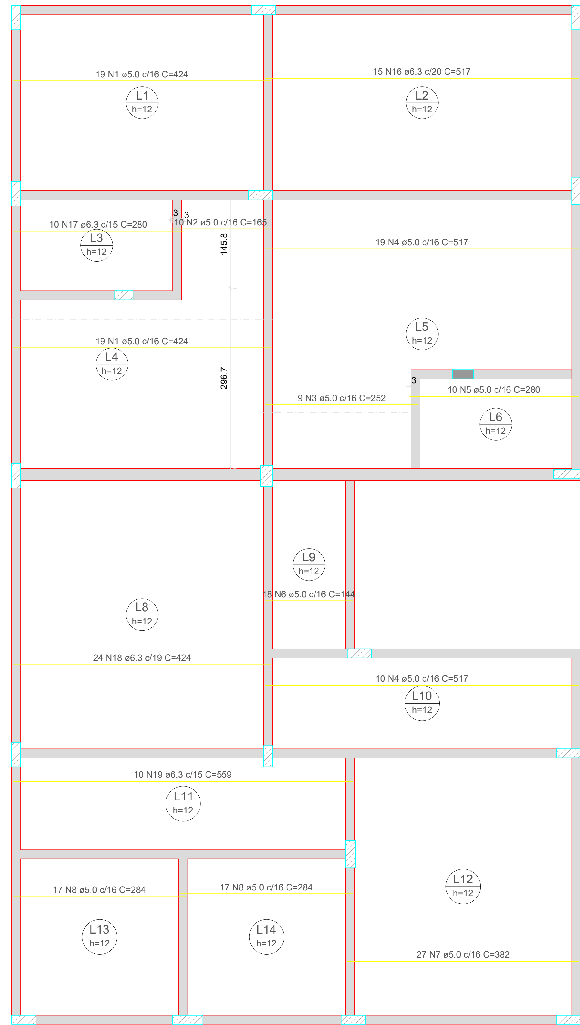
ARMAÇÃO POSITIVA DAS LAJES DO PAVIMENTO 1º PAVIMENTO (EIXO X)
