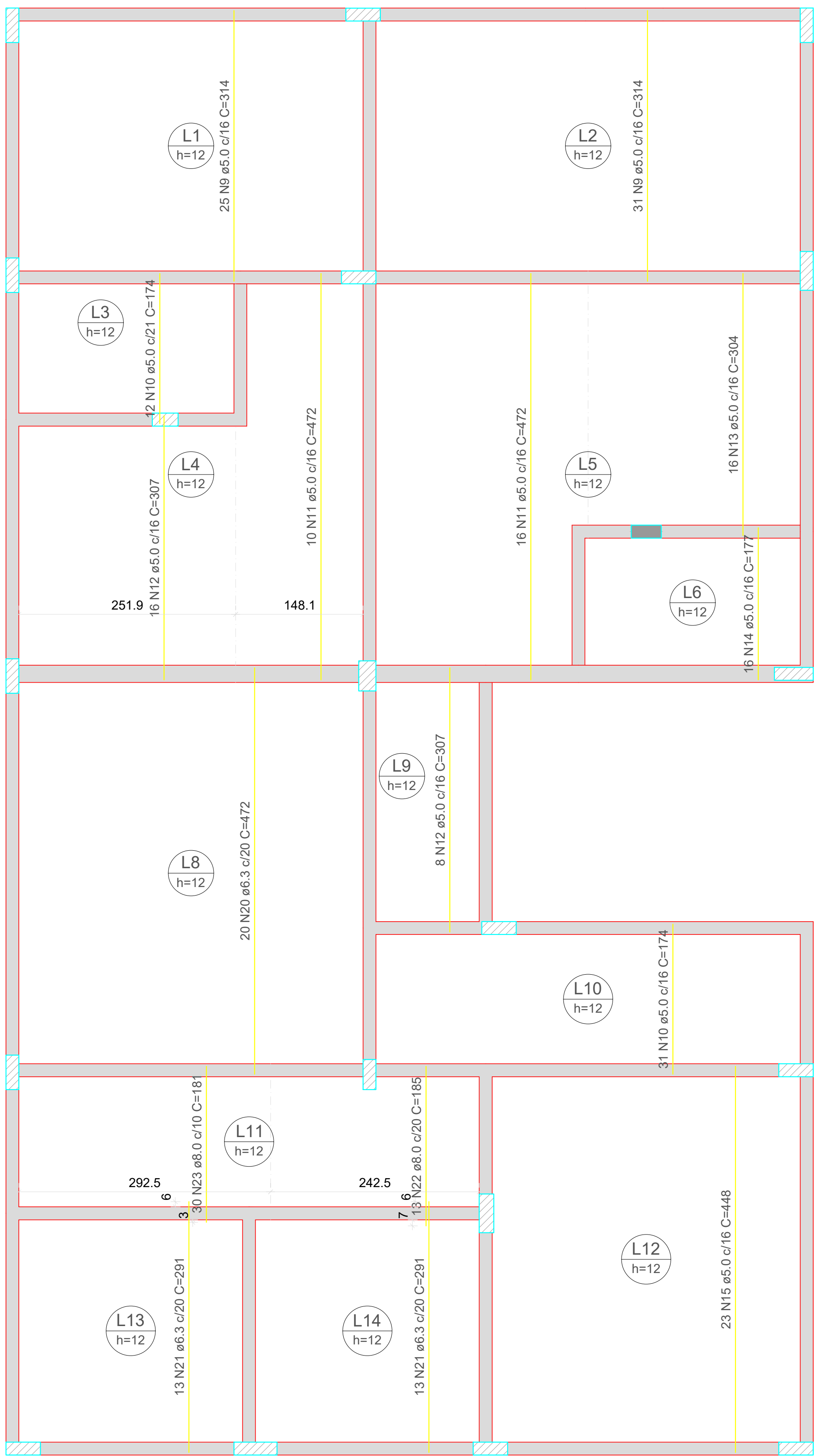
ARMAÇÃO POSITIVA DAS LAJES DO PAVIMENTO 1º PAVIMENTO (EIXO Y)
